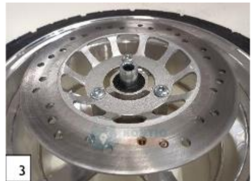
3 Asenna holkit molemmille puolin vanteen keskiöön. (kuvat 3 ja 4).
